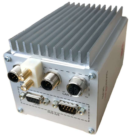
1) smartIO MVB integriert im smartRAIL MVB
